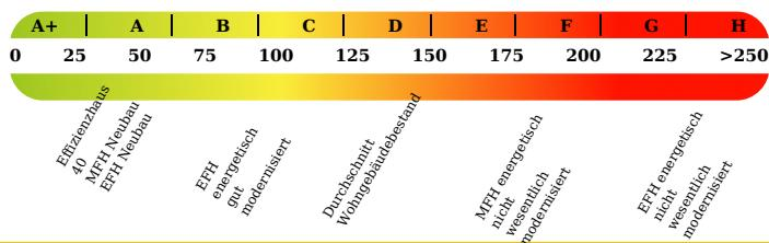
Die modellhaft ermittelten Vergleichswerte beziehen sich auf Gebäude, in denen Wärme für Heizung und Warmwasser durch Heizkessel im Gebäude bereitgestellt wird. Soll ein Energieverbrauch eines mit Fern- oder Nahwärme beheizten Gebäudes verglichen werden, ist zu beachten, dass hier normalerweise ein um 15 bis 30 % geringerer Energieverbrauch als bei vergleichbaren Gebäuden mit Kesselheizung zu erwarten ist.
