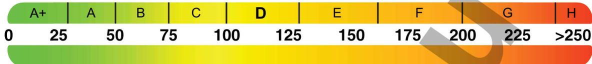
Primärenergiebedarf dieses Gebäudes 133 kWh/(m<sup>2</sup>·a)
