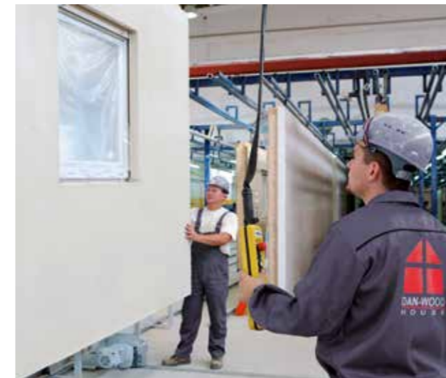
Die Wände werden in der Fabrik vorgefertigt...
